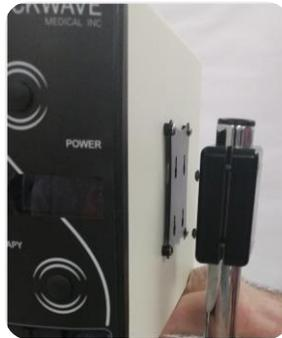
**Stap 5** – Bevestig de oplaadmodule van de batterij op dezelfde manier als de generator.
