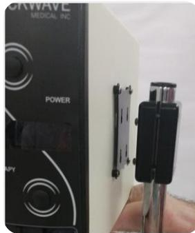
**Paso 5:** Monte el módulo del cargador de la batería de la misma manera que el generador.
