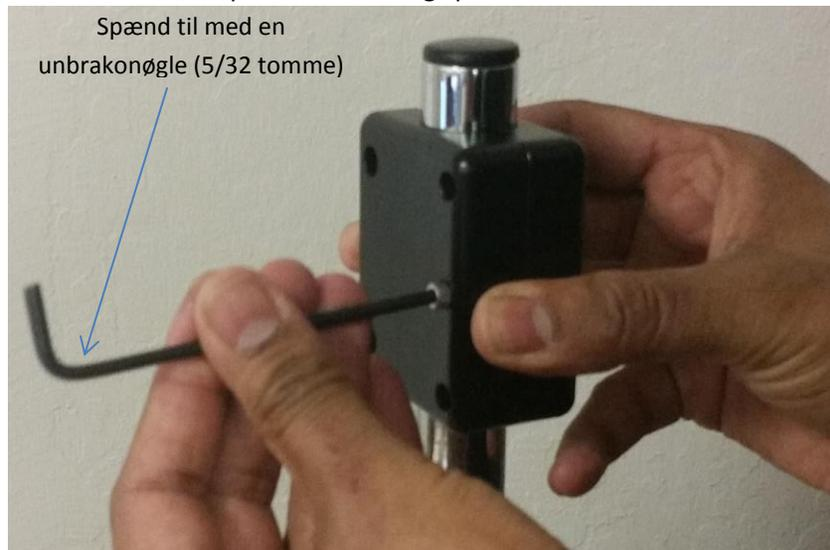
Isæt og spænd de resterende monterings- (2 stk.) og klemskruer (1 stk.).
