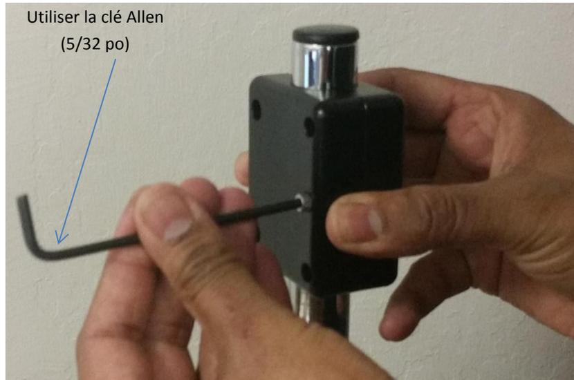
Installer et serrer les vis de montage (2) et de serrage (1) restantes.
