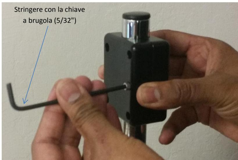
Inserire e stringere le 2 viti di montaggio e la vite di fissaggio rimaste.
