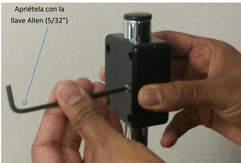
Instale y apriete los demás tornillos de montaje (2 unidades) y de la abrazadera (1 unidad).
