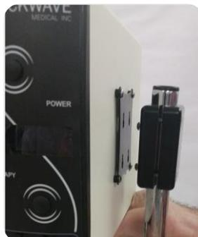
**Steg 5** – Montera batteriladdarmodulen på samma sätt som för generatorm.
