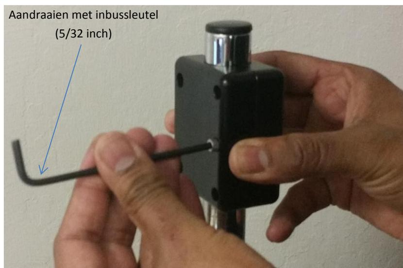
Installeren en aandraaien met de resterende bevestigingsschroeven (2 stuks) en klemmschroeven (1 stuks).
